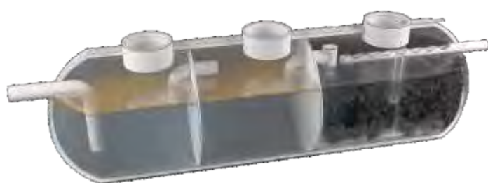
Filtro biológico compacto anaerobico
