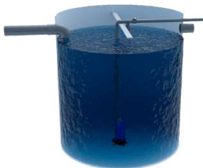
POZO DE BOMBEO
